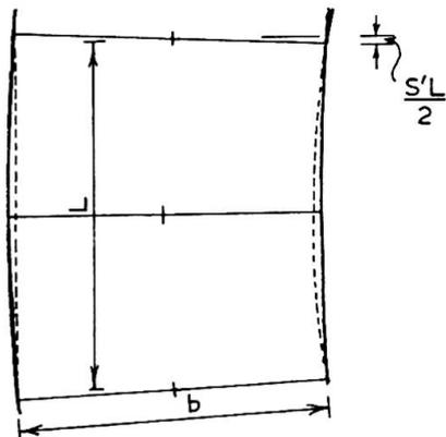
FIG 6. LOCALLY BUCKLED COLUMN UNDER BENDING STRAIN S'
