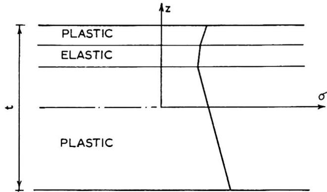
FIG 3 ASSUMED STRESS DISTRIBUTION IN THE ELASTO-PLASTIC SECTION.
