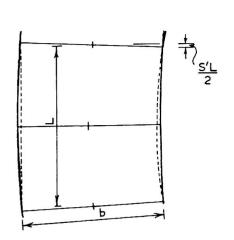
FIG 6. LOCALLY BUCKLED COLUMN UNDER BENDING STRAIN S'
