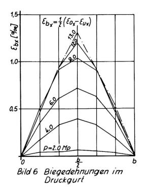
Auffallend ist, daß die Tragmomente der Versuchsträger sehr wenig streuen. Alle Träger beulten unterhalb der Traglast aus, waren aber in Abhängigkeit vom Schlankheitsgrad des Druckgurtes noch in der Lage, weitere
