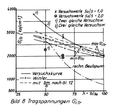
Die im Bild 8 mit & eingetragenen Versuchspunkte waren dazu gedacht, die Versuchsreihe der Träger I bis V in der Hinsicht zu bestätigen, daß die Tragfähigkeit der Kastenträger nur abhängig ist von den Plattenschlankheiten  $\lambda = b/s$  der Gurte, nicht aber von ihrer absoluten Dicke s bzw. vom Verhältnis 5./5. Diese Annahme wurde nicht bestätigt. Eine endgültige Erklärung für die im Versuch erhaltenen Ergebnisse konnte noch nicht gefunden werden.
