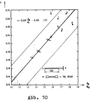
analysen von Profilen in den meisten Fällen an einfachen Flachzugproben durchgeführt werden, sind für das gleiche Bandmaterial aus gleichen Versuchen die nach den Gl. (2) und (3) ermittelten Größen (•1 - 6) angegeben.
