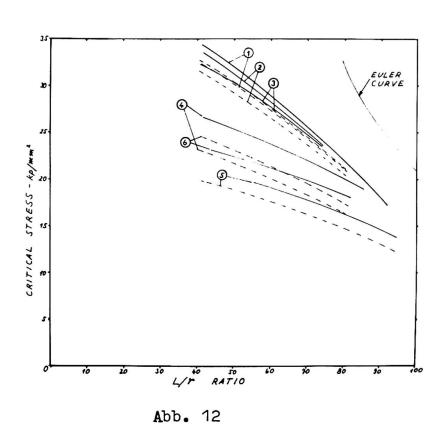
In allen Fällen lag reine Biegeknicken vor, also kein Biegedrilloder Drillknicken. Bei Hohlprofilen als Rohr oder als Kasten über die Vorstufe als Rohr gewalzt, liegt die kritische Spannung infolge der größeren Streckgrenzenerhöhung in den flachen Teilen (s. Abb. 12) in der Nähe des
