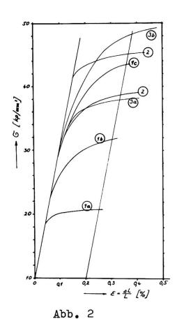
werte bei einem U-Profil. Die  $\mathbf{6}_{0,2}$ -Dehngrenze steigt am stärksten an, während die Zugfestigkeit geringfügig angehoben wird. Die Bruchdehnung fällt nicht unter  $\mathbf{6}_{10}$  = 10 % ab.
