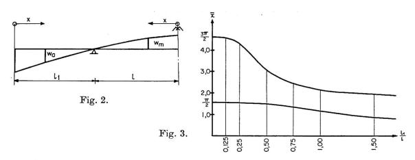
von  $\frac{l_1}{l}$  eingetragen. Für die praktische Berechnung nimmt man am besten drei äquidistante Werte für  $\kappa$  in der Umgebung des den Diagrammen der Fig. 3 entnommenen Näherungswertes an und bestimmt die Abweichung der rechten Seite der Gleichung (4) von Null. Eine sehr genaue Näherung kann dann durch quadratische Interpolation erhalten werden.
