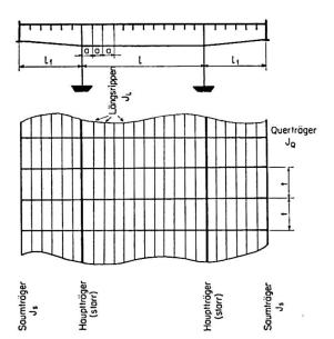
Fig. 1. Orthotrope Platte.
