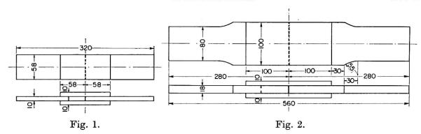
(35—40 kg/mm²). Die Berührungsflächen von je 6 Prüfstäben beider Formen wurden mit Stahlkies der Körnung 2—3 mm bei 5—6 atü gestrahlt, bis sie metallisch rein waren, dann mit einem kalthärtenden Polyesterharz verklebt.
