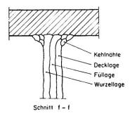
Fig. 14. Schnitt «ff» zu Fig. 8. Obergurtseite der CO<sub>2</sub>-Steignaht.
