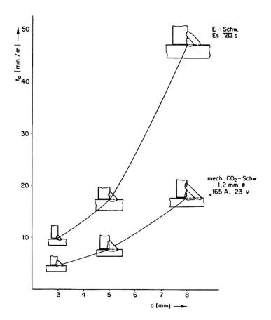
Fig. 4. Schweiß-Operativzeiten  $t_0 = t_G + t_H$  (min/m) für Kehlnähte (senkrecht-steigend) in Abhängigkeit von der Blechdicke s (mm).
