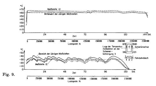
Tafel 4. Ergebnis der Dauerversuche mit Klebemörtel-Keilplatten
