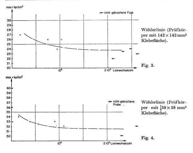
Eine praktische Anwendungsmöglichkeit für geklebte Stahlverbindungen sah die Deutsche Bundesbahn, aus den unter Abschnitt 1 angeführten Gründen, nach einer Verbesserung der Festigkeit der Kleber darin, die Unterlagsbzw. Ausgleichsplatten unmittelbarer Schienenbefestigungen auf mittragende Fahrbahnbleche stählerner Brücken anstatt zu schweißen, zu kleben.
