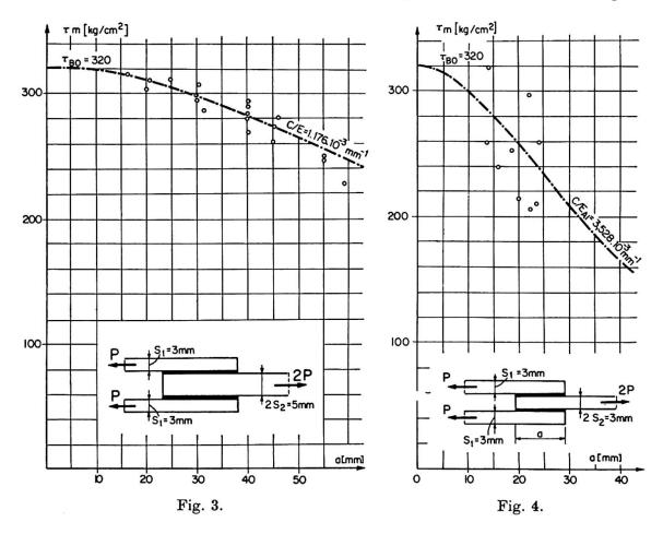
Stoßlaschendicke wurden die Annäherungsformeln durch die Versuchsergebnisse ebenfalls bestätigt. Beim Zusammenkleben von drei 3-mm-Blechen  $(s_1 = 3.0 \text{ mm}, s_2 = 1.5 \text{ mm})$  erhöhte sich die mittlere Scherspannung durch die Schwächung der Stoßlaschen von 258 kg/cm² auf 285 kg/cm², die Tragfähigkeit der Verbindung stieg also auf das 1,102fache. Derselbe Wert ergibt sich theoretisch zu 1,103.
