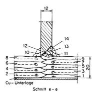
Fig. 12. Schnitt «e-e» zu Fig. 8. Schema des Nahtaufbaues der CO<sub>2</sub>-Schw. am Untergurtstoß bei einer HV-Nahtausbildung des Stegbleches.
