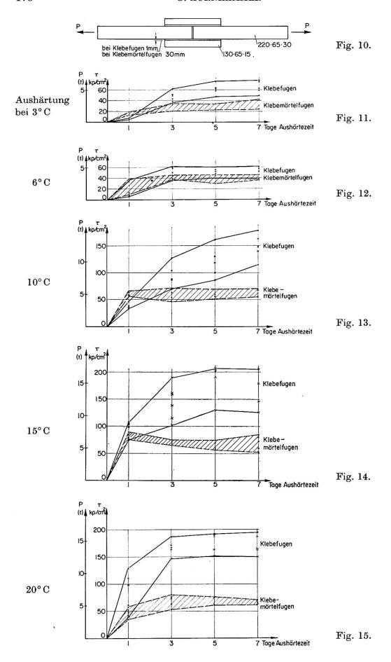
und Epoxydharzmörtel mit Quarz. Die Form der Prüfkörper aus St 37 ist der Fig. 10 zu entnehmen. Von den insgesamt 200 Probekörpern standen je 5 für die verschiedenen Prüfungen zur Verfügung.
