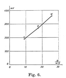
Zur Abklärung der Existenz des Pumpeffektes der Risse infolge oftmals wiederholter Belastung wurden in Fig. 6 sämtliche Risse der zusammengehörigen Balken zu einem Mittelwert zusammengefaßt. Als Abszisse ist aufgetragen ein Maß für die Rostgefahr oder Rostintensität, in dem die Länge der Verrostung (R) durch die Weite der Risse (w) und diese durch die Dicke der Betondeckung (d) dividiert wurden.
