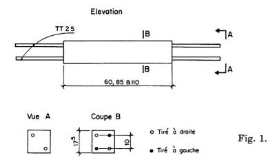
La première série d'essais, encore en cours, porte sur les prismes à section carrée armés aux angles de quatre aciers Tentor de 25 mm que définit la fig. 1 quant à leurs dimensions et à la disposition relative des barres longitudinales en jonction. La résistance du béton de ces prismes, mesurée sur cylindres, était de 300 kg/cm².
