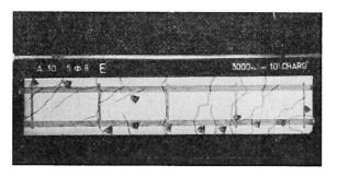
Fig. 4. Fissuration de l'éprouvette de 30 diamètres, cousue de 5 cadres de 8 mm (couture au 1/2), sous charge de service (3000 kg/cm<sup>2</sup>).
