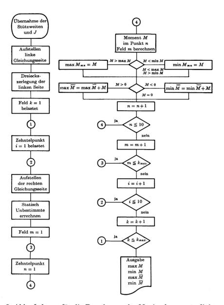
Fig. 3. Ablaufschema für die Berechnung der Maximalmomentenlinie.
