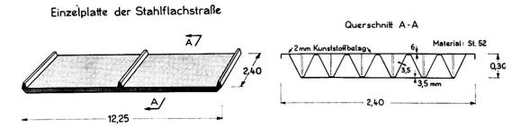
Fig. 5. Einzelplatte der Stahlflachstraße.
