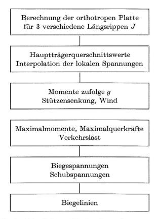
Fig. 1. Ablaufschema für das Gesamtprogramm.
