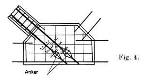
den auch die Trägermodelle aus vorfabrizierten Elementen zusammengesetzt und mit Ortsbeton verbunden, außer den Zugstreben, die, wie bereits erwähnt, mit den Knotenblöcken zusammen im Spannbett hergestellt wurden. Die vorfabrizierten Elemente wurden aus Beton B 400 hergestellt, als Ortsbeton wurde Beton B 450 verwendet. Die Knotenwände wurden mit einem leichten Armie-
