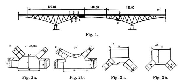
die Streben und die Knotenblöcke verschiedene Dicke auf, sind aber monolithisch miteinander verbunden. Im Knoten U1 sind die Streben ohne, bei U2 dagegen mit Vouten, entsprechend Fig. 2a, ausgebildet; der Knoten U4 wiederum wurde gemäß Fig. 2b ausgeführt.
