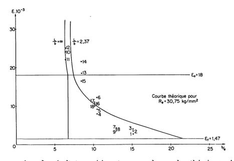
Fig. 7. Comparaison des résultats expérimentaux avec les courbes théoriques. Acier A 42.
