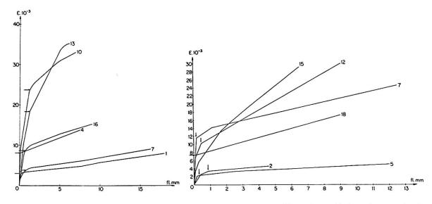
Fig. 5. Diagramme dilatationsflèches des essais de compression sur cornières en A 42.
