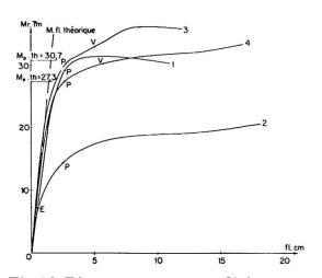
Fig. 12. Diagramme moments-flèches pour les nœuds en acier A 52.
