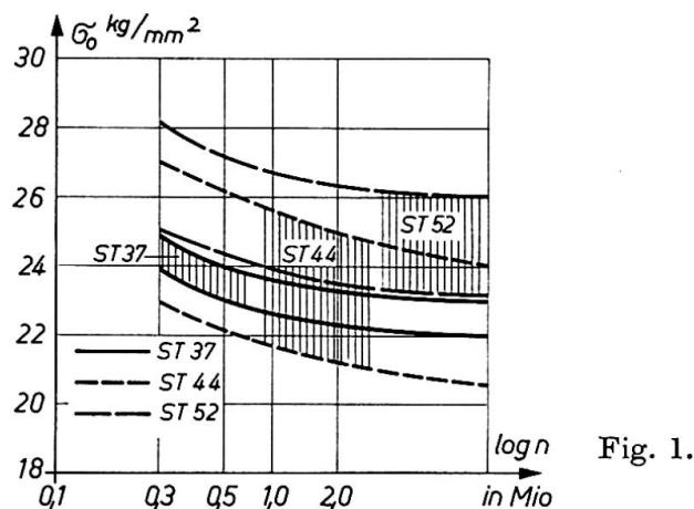
und unteren Berandungen der Wöhlerkurven eingetragen, so daß man daraus den Streubereich der Versuche erkennen kann. Die Figur zeigt, daß dieser Streubereich für St 37 am kleinsten und für St 44 am größten ist, während jener des Baustahles St 52 zwischen diesen beiden Werten liegt. Diese Tat-
