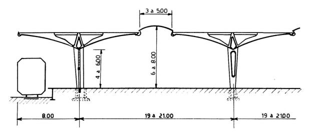
Fig. 13 - Halle d'usine, coupe transversale (Boussiron).
