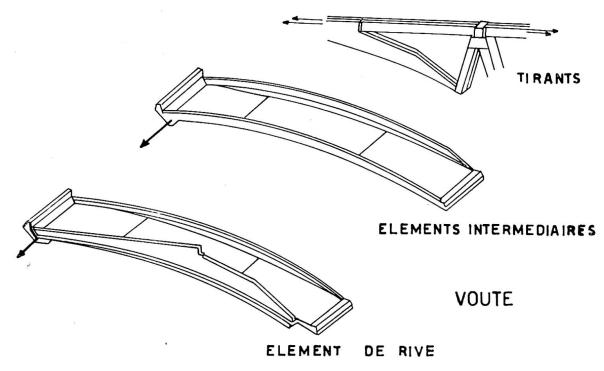
Fig. 16 - Eléments de couverture.
