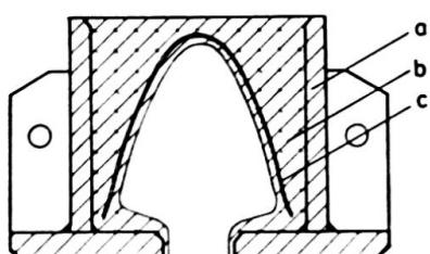
Fig. 2. Aufbau der Gummimetalfeder.
