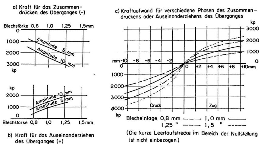
Fig. 11. Verformung unter horizontaler Belastung bei verschiedener Blechstärke.
