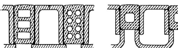
Fig. 1. Elastohohlleisten zwischen tragenden Stahllamellen.
