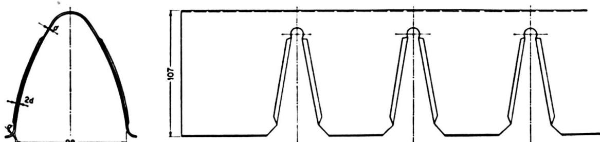
Fig. 4. Form der Blecheinlage für schiefe elastische Übergänge.
