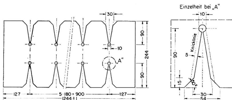
Fig. 5. Zuschnitt der Blecheinlage für schiefe elastische Übergänge.
