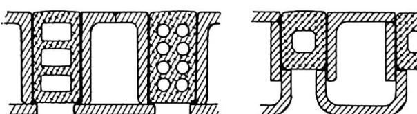
Fig. 1. Elastohohlleisten zwischen tragenden Stahllamellen.
