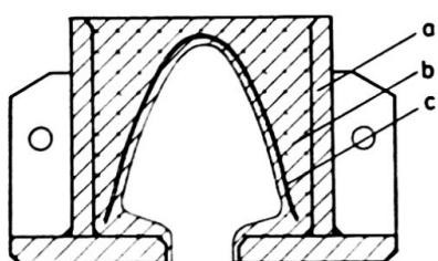
Fig. 2. Aufbau der Gummimetalfeder.
