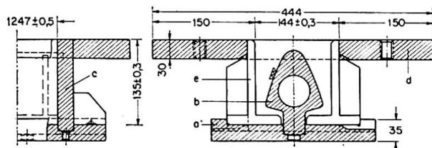
Fig. 8. Preßwerkzeug — Heizform — für Fahrbahnelemente.
