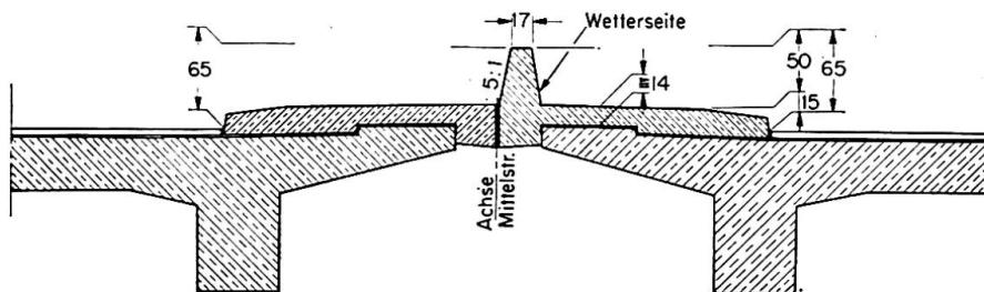
Fig. 8. Leitschwelle auf dem Mittelstreifen — neben der Trennungsfuge.
