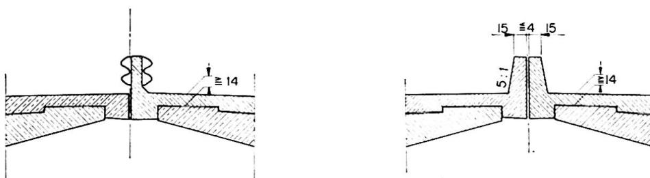
Fig. 9. Leitschwelle auf dem Mittelstreifen — Stahlleitplanke an Beton-Leitschwelle.
