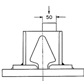
Fig. 9b. Vertikale Belastung seitlich (Versuchsanordnung).
