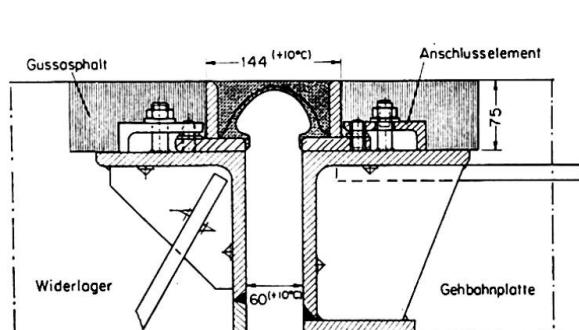
Fig. 12b. Anschluß des Gehbahnüberganges an die Unterkonstruktion.
