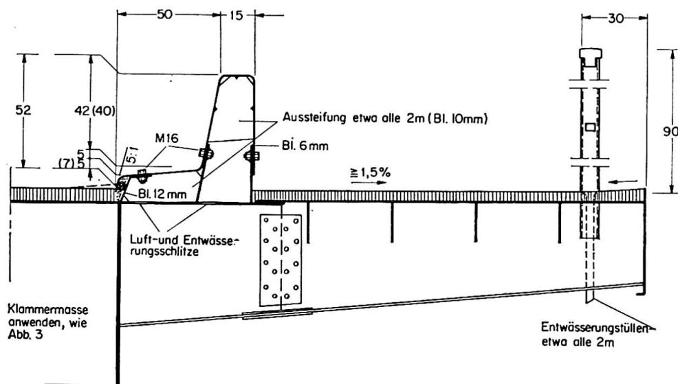
Fig. 6. Leitschwelle aus Stahl mit tiefliegendem Gehweg.
