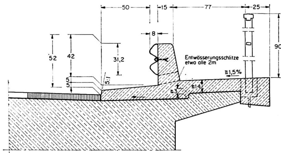
Fig. 3. Durchlaufende Stahlleitplanke vor Beton-Leitschwelle mit senkrechter Vorderkante.
