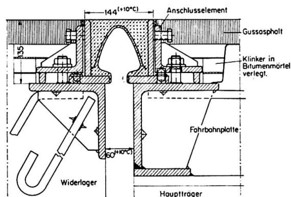
Fig. 12a. Anschluß des Fahrbahnüberganges an die Unterkonstruktion.
