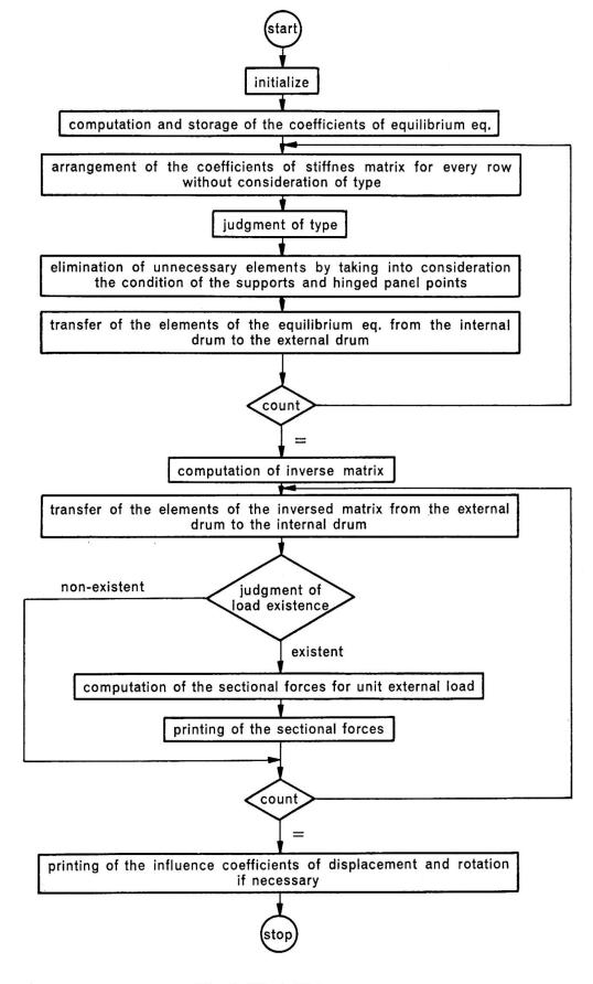
Fig. 2. Block Diagram.
