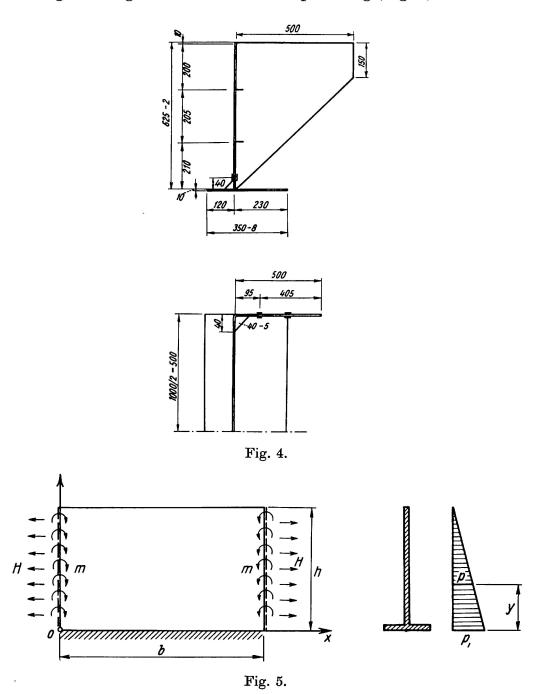
Ad 1. Für die dreieckförmig verteilt angenommene Erddruckbelastung ist es gelungen, nach GIRKMANN: *Flächentragwerke*, eine genaue analytische Lösung zu finden. Es gilt:
