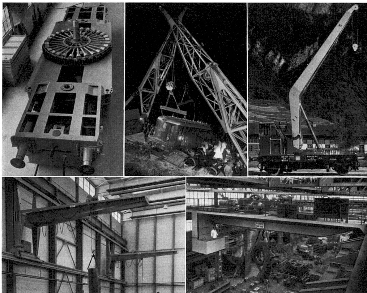
Fig. 5. De gauche à droite et de haut en bas: châssis d'un wagon-grue de 25 t, wagons-grues de 25 t au travail, wagon-grue de 4 t, grues-console et pont roulant d'atelier.
