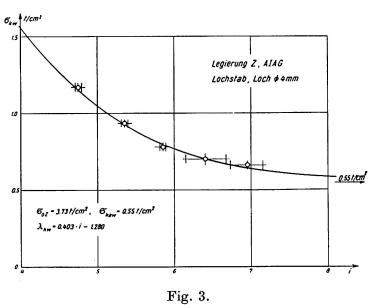
Spannung  $\sigma_w$ , durchgeführt mit einem Hochfrequenzpulsator Bauart Amsler und die daraus berechnete Kurve der Wechselfestigkeit  $\sigma_w$ . In der nachstehenden Tabelle sind die Ergebnisse der drei Programmversuche mit dem Minimum, dem Maximum und dem Mittelwert aus je vier Einzelversuchen zusammengestellt. Das Ergebnis der Versuche von A. M. Freudenthal wird somit nicht bestätigt.
