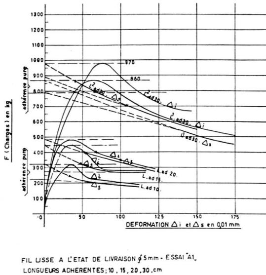
Fig. 4. Fil lisse: variation de l'effort d'extraction du fil en fonction du déplacement pour différentes longueurs adhérentes.
