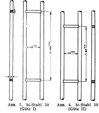
binder erfolgt mittels elektrischer Widerstandschweissung, wobei der Schweissvorgang so gesteuert wird, dass ein stetiger Übergang zwischen dem Gefüge des Querverbinders und der Längsstäbe S. MsKr erfolgt so stark, dass die gerade zugeschnittene Sprosse ein Viertel bis ein Drittel
