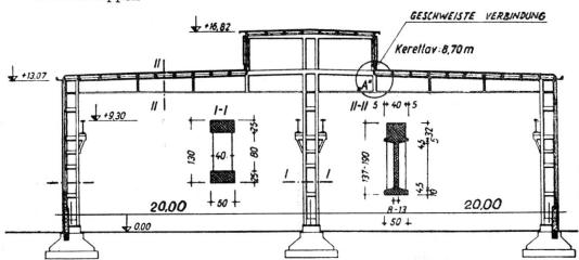
BILD 7. Querschnitt einer zweischiffigen Halle
