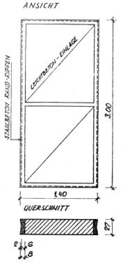
BILD 5. Wandpanel mit Stahlbetonrippen
