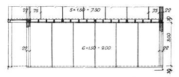
BILD 4. Wohngebäude mit Wandplatten aus Schlackenbeton
