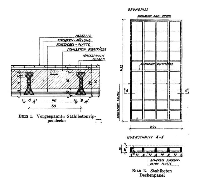
hergestellt. Das Gewicht eines Panels ist rund 1,5 Tonne und der Transport kann mit Lastkraftwagen, das Versetzen mit einem Turmdrehkran durchgeführt werden.
