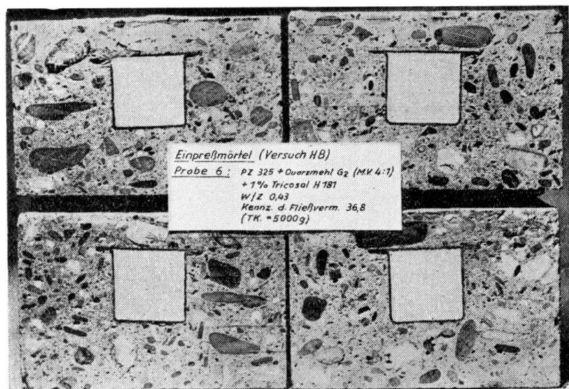
ABB. 7. Einfluss der Zusatzmittel auf den Einpressmörtel
