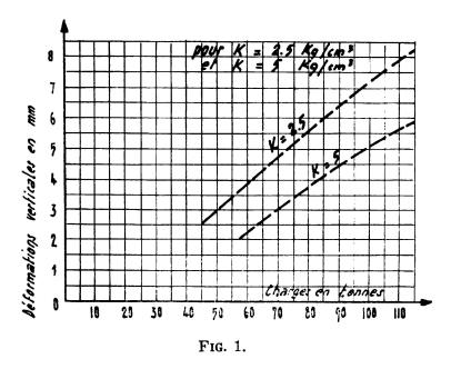
Fig. 1. Déformations verticales au centre de la charge.
