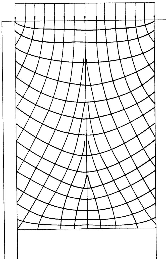
FIG. 3. Isostatiques de la poutre simplement appuyée
