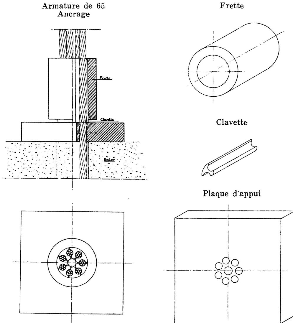
sur le béton par appui sur une plaque d'acier permettant la répartition des pressions sur une surface suffisante.
