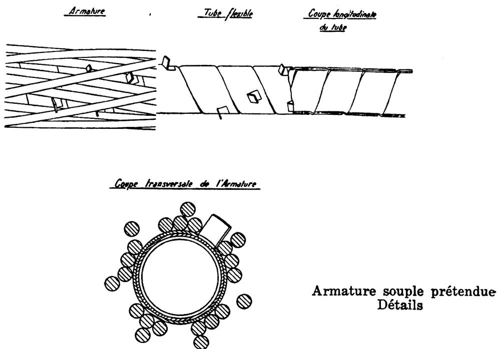
ment du béton. Grâce au support provisoire intérieur, le matériel nécessaire à la mise en tension n'est immobilisé que quelques heures par armature. Il serait du reste difficile d'obtenir au moyen d'ancrages fixes, sans dépense excessive, des forces de précontrainte aussi importantes que celles mises en oeuvre par l'emploi simultané de plusieurs armatures souples prétendues (90 tonnes par armature).
