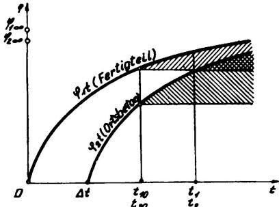
ABB. 1. Kriechkurven der Trägerteile. Die Belastung beginnt zur Zeit  $t_{10}$  bzw.  $t_{20}$
