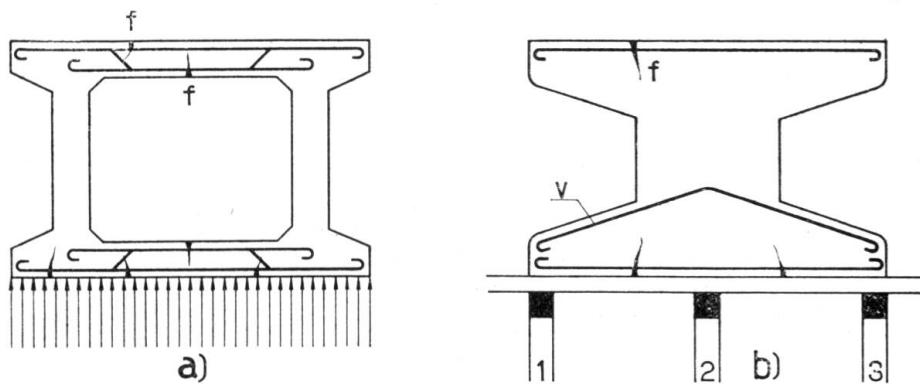
FIG. 5. Esquema das secções dum arco vazado (a) e dum arco aligeirado (b). Localização das possíveis fendas
