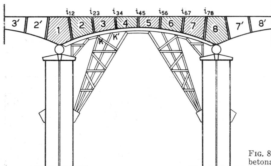
FIG. 8. Viga contínua betonada por aduelas
