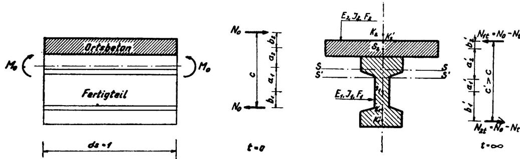
ABB. 3. Innere Kräfte in einem Stahlbeton-Fertigteilträger mit Druckplatte zur Zeit  $t=0$  und  $t=\infty$
