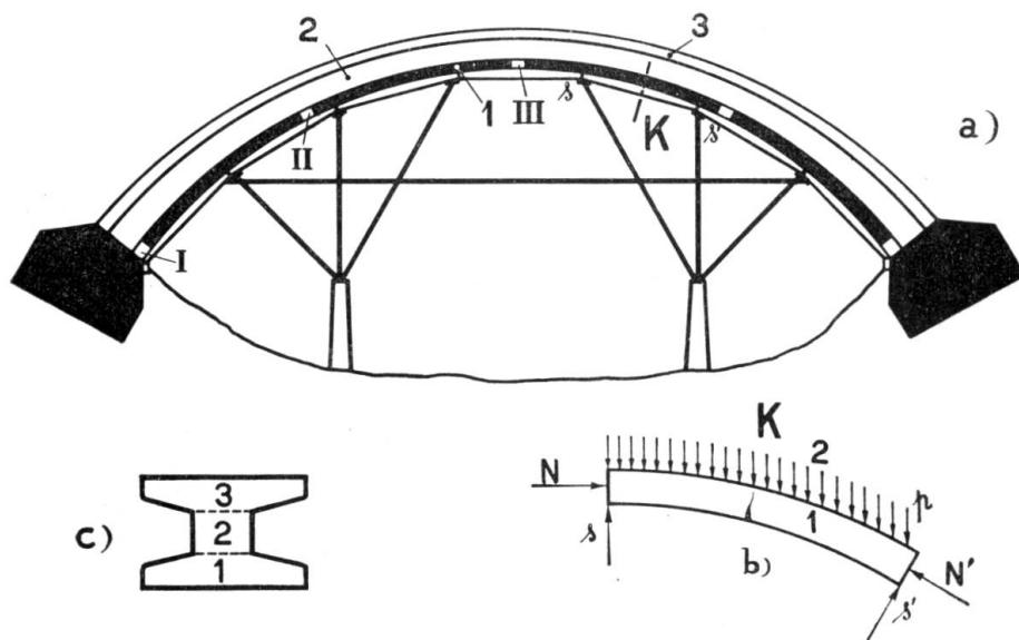
FIG. 1. Esquema dum arco betonado por camadas
