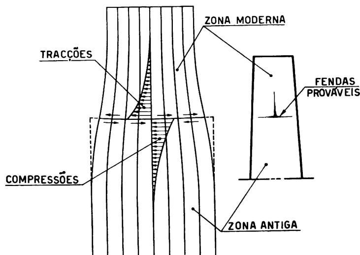
FIG. 17. Tensões devidas à contracção diferencial num arco betonado por anéis
