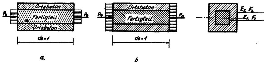
Abb. 2. Zusammengesetzter und an Ort und Stelle verbundener Druckstab. Abb. 3-a. Die Last  $P_o$  wird nur von dem Fertigteil getragen. Abb. 3-b. Die Last  $P_o$  wird von dem Verbundträger getragen
