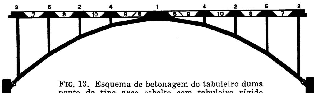
FIG. 13. Esquema de betonagem do tabuleiro duma ponte do tipo arco esbelto com tabuleiro rígido
