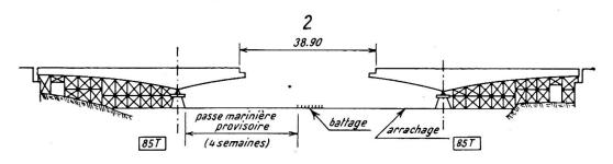
Battage des pieux et échafaudages des consoles-culasses-Coffrage-Ferraillages. Coulage du béton des 2 consoles-culasses en ménageant un joint de 0 m. 75 à 0 m. 50 de l'axe des piles, exécuté en dernier lieu-mise en place des câbles et tension des câbles jusqu'à 85 tonnes.
