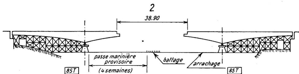
Battage des pieux et échafaudages des consoles-culasses-Coffrage-Ferraillages. Coulage du béton des 2 consoles-culasses en ménageant un joint de 0 m. 75 à 0 m. 50 de l'axe des piles, exécuté en dernier lieu-mise en place des câbles et tension des câbles jusqu'à 85 tonnes.
