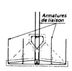
Fig. 12. Coupe d'un arc préfabriqué
