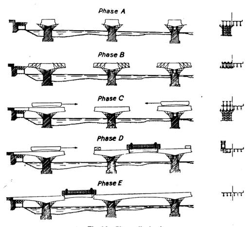
Fig. 16. Phases d'exécution
