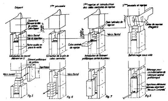
Fig. 29. Phases élémentaires d'une journée courante de levage
