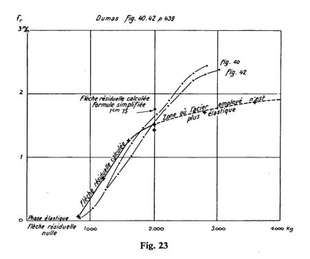
contrainte moyenne de l'acier de 1 200 kg. appliquée aux calculs classiques conduit à une flèche d'environ 6 mm. 5, sous une charge de 2 000 kg., en admettant que toute la poutre se comporte comme la zone fissurée—l'expérience a donné de 6 à 6,3 mm.
