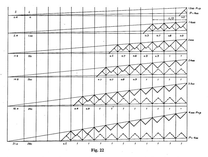
dans laquelle v, distance des barres tendues à la fibre neutre, est 18,5 et  $\Delta L$  est obtenu en multipliant l'aire S de la somme des triangles de déformation résiduelle par le facteur 5 200:
