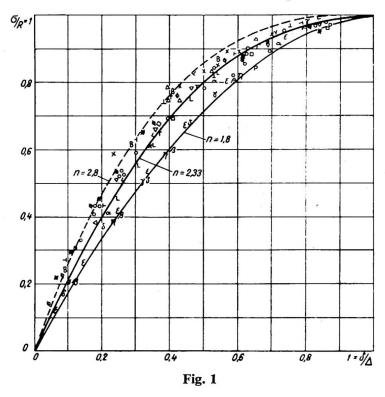
L'étude rhéologique du comportement élasto-plastic-visqueux du béton en compression démontre que, quand elles deviennent des déformations relatives rapport à la déformation de rupture, ces altérations supportées par le diagramme, d'un cas à un autre, sont pratiquement négligeables et comprises dans le champ normal de fluctuation correspondant à la dispersion naturelle des résultats sur des éprouvettes différentes fabriquées avec des bétons de caractéristiques analogues.
