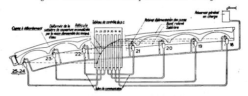
Fig. 30. Dispositif de contrôle centralisé des déformations
