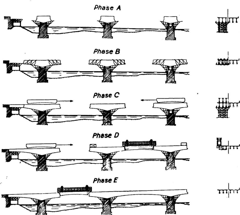
Fig. 16. Phases d'exécution
