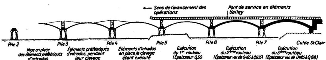
Fig. 14. Phases d'exécution de l'ensemble de l'ouvrage
