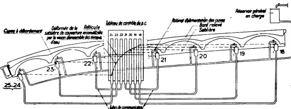
Fig. 30. Dispositif de contrôle centralisé des déformations
