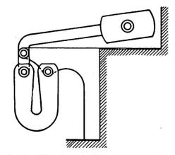
Fig. 2. Montage de l'éprouvette en U
