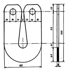
Fig. 1. Eprouvette en U
