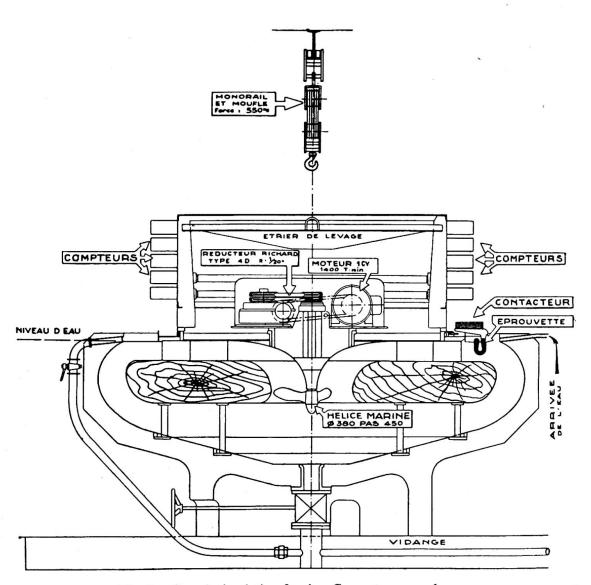
Fig. 3. Cuve à circulation forcée—Coupe transversale
