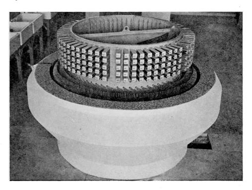
Fig. 4. Cuve à circulation forcée avec son appareillage
