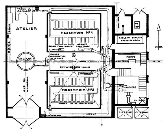
Fig. 6. Station d'essai des ciments par corrosion accélérée du Port Autonome du Havre C.R.—48
