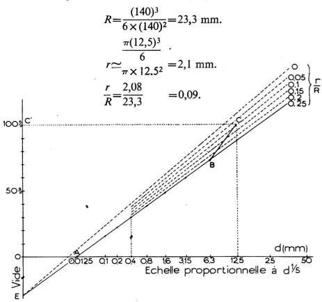
Fig. 3. Volume absolu de matériaux solides passant à travers les passoires
