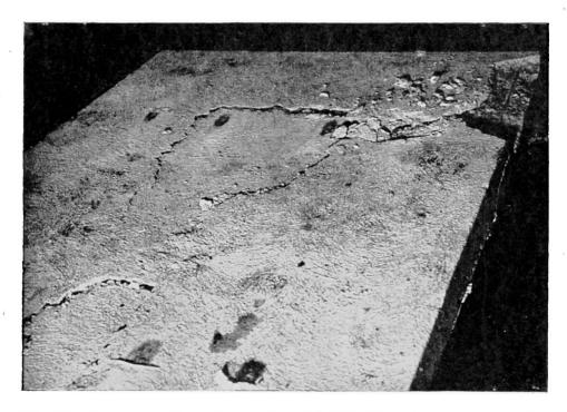
Fig. 14. Rupture en 2ème phase de l'essai à l'effort tranchant du panneau de 9 cm.
