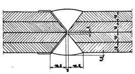
Fig. 14. Coupe des cordons de soudure pour les semelles, dans la partie courante.
