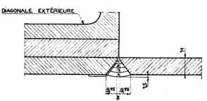
Fig. 12. Coupe des cordons de soudure de la partie contre la diagonale tendue.
