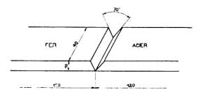
Fig. 3. Forme et dimensions de l'éprouvette de pliage.
