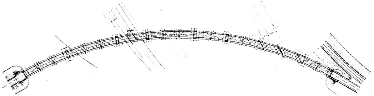
Abb. 14. Ansicht einer Eisenbahnbrücke mit konstantem Krümmungshalbmesser.
