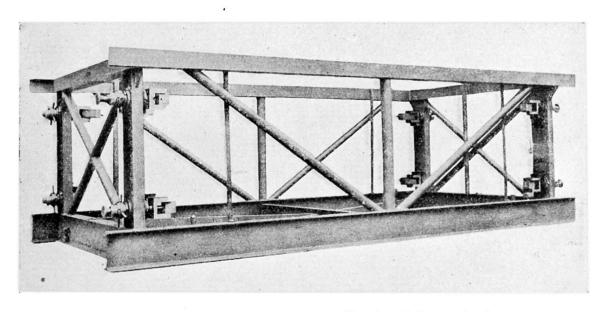
Abb. 21. Messvorrichtung zur Kontrolle der Toleranzforderung.
