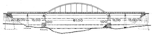
Abb. 1. Ansicht der Brücke in vollständig geschweisster Ausführung.
