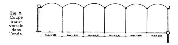
Au point où le talon d'une onde rencontre la poutre-sablière, s'attache le tirant. A l'une des extrémités du tirant les ronds s'ancrent, extérieurement à la voûte, dans un culot en béton armé et l'intervalle qui sépare celui-ci de la sablière permet de loger des vérins pour la mise en tension (fig. 3). Celle-ci s'effectue sur les ronds d'abord laissés nus, et en deux
