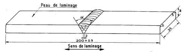
Fig. 4. Forme et dimensions de l'éprouvette de l'essai de pliage d'un joint soudé.
