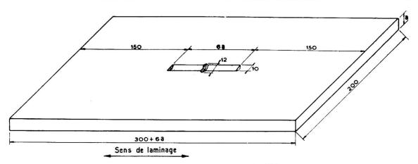
Fig. 14. Forme et dimensions de l'éprouvette de l'essai de pliage avec rainure et entaille.
