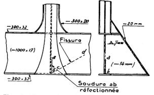
Fig. 4. Fissuration de l'âme d'une membrure inférieure lors de la réfection d'une soudure.
