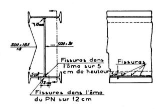
Nature de l'accident : fissuration de l'âme d'une membrure.
