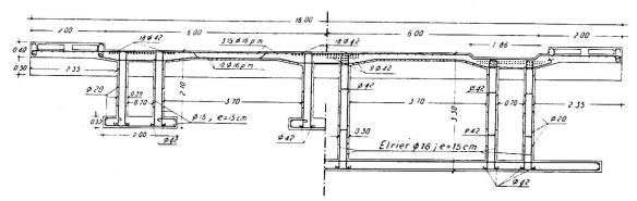
Fig. 12. Coupe transversale de la maîtresse-poutre.
