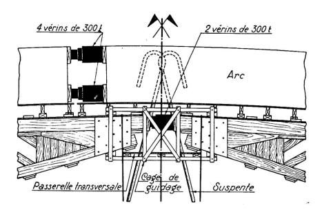
**Fig.** 5. Disposition des vérins à la clef.
