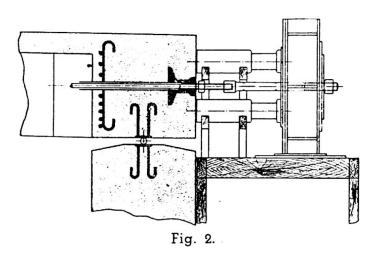
sont libres sur toute la longueur de la poutre et traversent les extrémités de celle-ci dans des gaines ménagées lors du bétonnage.
