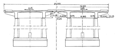
Fig. 10. Section transversale du pont - route à Senohraby.
