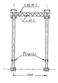
**Fig. 4.** Coupe transversale du pont de Pedrido.
