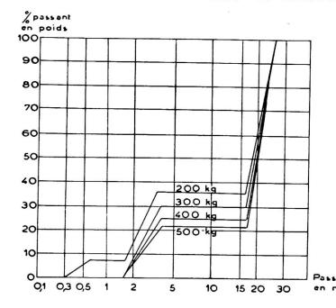
Fig. 3. Granulométrie optimum du béton de gravillon suivant dosages.
