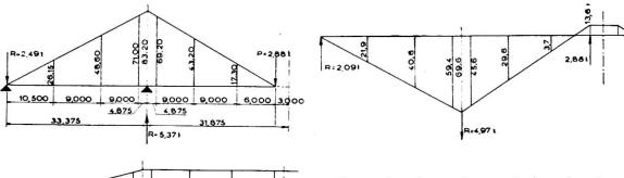
Fig. 4 (en haut, à gauche), 5 (en haut, à droite) et 6 (en bas, à gauche). Diagrammes des moments.
