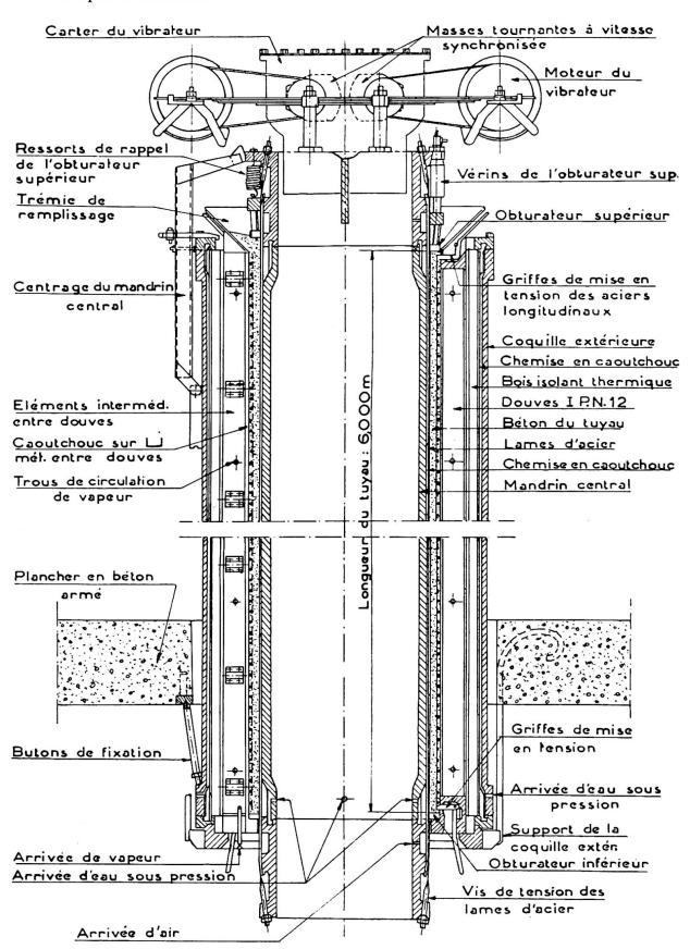
Fig. 2. Coupe diamétrale d'un moule.
