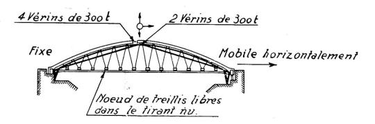
Les arcs achevés un changement de suspension fut opéré. Par l'intermédiaire des plots du garde-corps les charges du tablier furent accrochées directement aux suspentes définitives. Le tablier fut alors réalisé hormis la partie supérieure du tirant et les trottoirs afin de permettre l'allongement des aciers jusqu'à la limite des possibilités.
