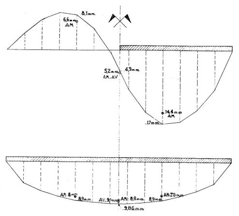
Fig. 10. Flèches enregistrées durant les essais.
