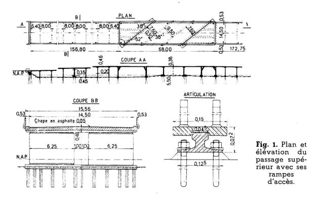
Des balustrades sont placées extérieurement à ces bordures. La chaussée du viaduc est couverte d'une chappe d'asphalte de 5 cm d'épaisseur.
