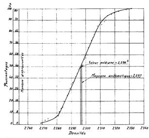
Fig. 17. Eprouvettes nº 4 - Mortier. Densités.
