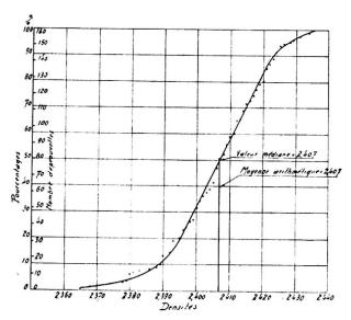
Fig. 19. Eprouvettes nº 2 - Béton. Densités.
