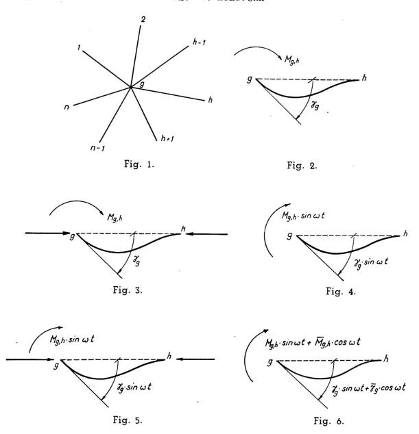
une construction se trouvant dans l'équilibre instable à la limite du flambage.
