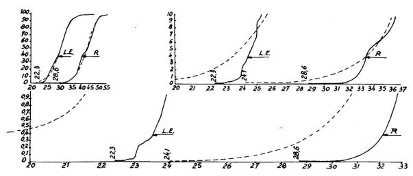
Fig. 1. Fréquence en % des résistances et limites élastiques inférieures à une valeur donnée (abscisse en kg/mm²).
