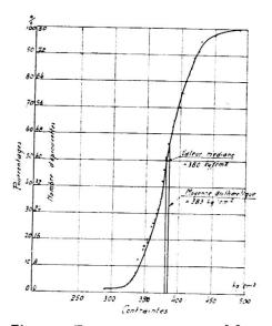
Fig. 18. Eprouvettes nº 4 - Mortier. Contraintes de rupture par compression.
