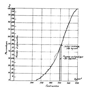
**Fig. 14.** Eprouvettes n° 2 - Mortier. Contraintes de rupture par compression.
