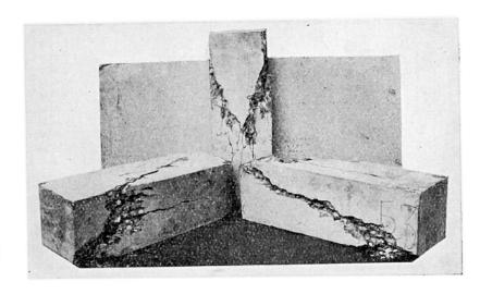
Fig. 23. Eprouvettes nº 4, de béton, rompues par compression.
