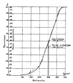
**Fig. 20.** Eprouvettes nº 2 - Béton. Contraintes de rupture par compression.
