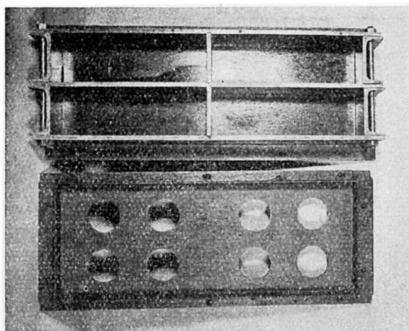
Fig. 5. Moule pour éprouvettes type n° 2, avec son couvercle.
