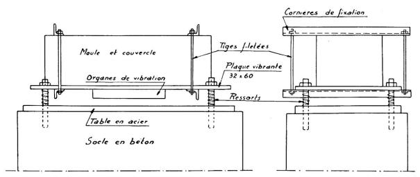
Fig. 7. Fixation des moules sur la table vibrante.
