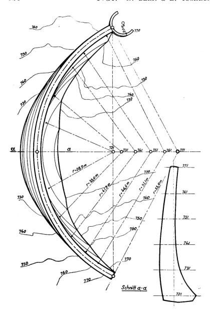
**Abb. 1.** Salzasperre. Lageplan mit Talsohlenquerschnitt.
