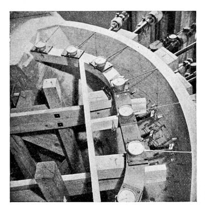
**Abb. 3.** Versuchsmodell. Anordnung der Messuhren am Kronenbogen.
