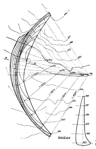
**Abb. 2.** Hierzmannsperre. Lageplan mit Talsohlenquerschnitt.
