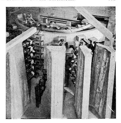
**Abb. 5.** Versuchsmodell. Abstützung der Belastungsfedern.
