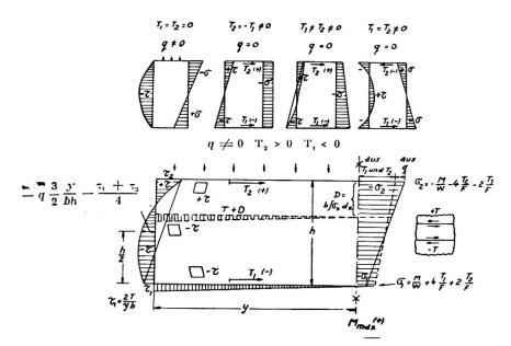
Abb. 3. Schubspannungen in der Scheibe.
