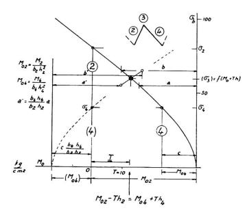
**Abb. 1.** Ermittlung der Längsdruckspannung bei zwei zusammenhängende Scheiben.
