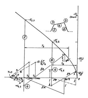
Abb. 2. Ermittlung der Längsdruckspannung in drei zusammenhängende Scheiben.
