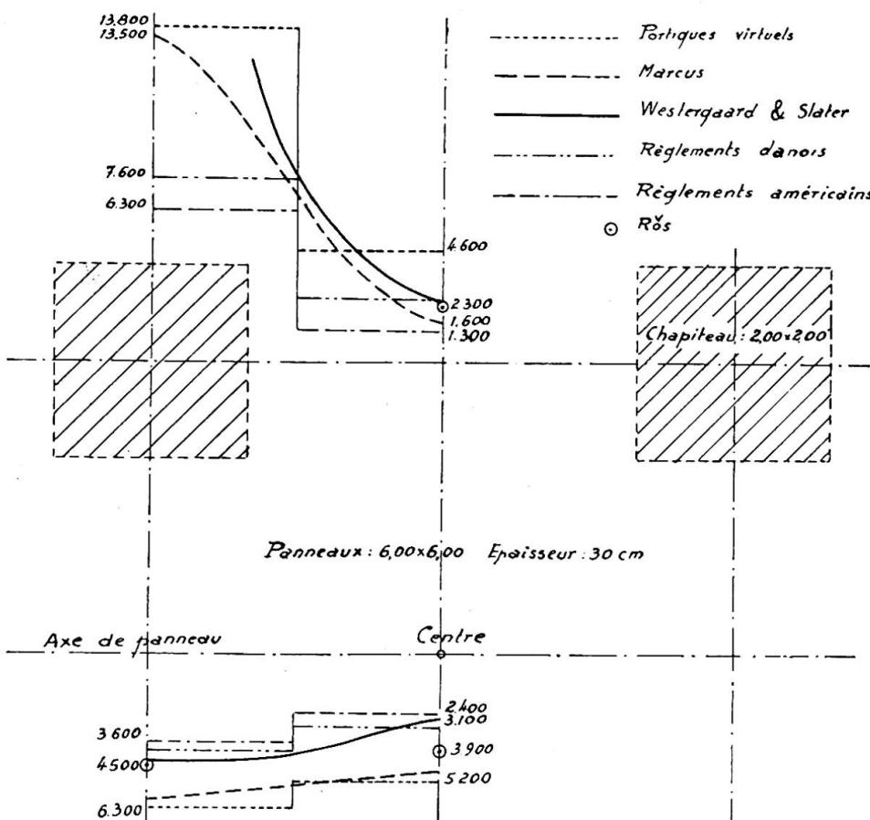
**Fig. 9.** Comparaison des résultats obtenus par diverses méthodes dans un panneau de la dalle de l'entrepôt de Passajes.
