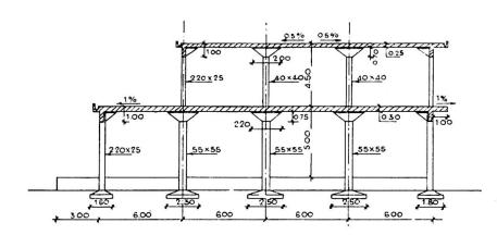
Fig. 6. Section transversale du Magasin visible à la figure 5.
