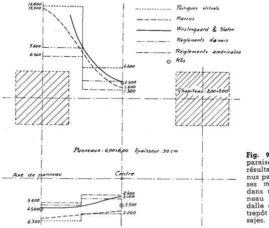
Fig. 9. Comparaison des résultats obtenus par diverses méthodes dans un panneau de la dalle de l'entrepôt de Pasajes.
